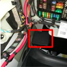
4.9、接 ECU 插头，将 ECU 安放在右侧图示位置，并固定好。
