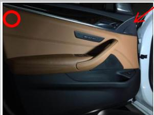
1.3、当把螺丝拆下后首先从右侧（箭头）位置开始拆门板，左侧（圆圈）内部有扣，需拆下
