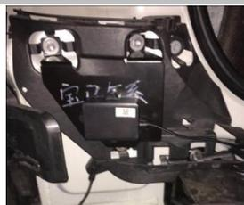
3.2、将雷达装到雷达支架上，注意区分左右。将雷达支架装到原车上
