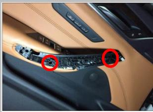
1.2、拆下原车螺丝，位置如图中红色圈所示，再用撬板拆下门板。（左右方法一致，只描述左边）
