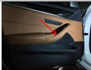
1.1、把原车装饰条拆下，然后拆下原车门板
