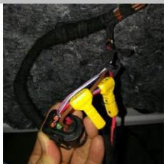
1.6、门边取电线束，拆除门板可看到走线，红蓝色接电源正（+）极，棕色接电源负（-）极。左右一致，只描述一边
