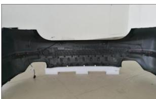
2.8、当所有螺栓全部拆下后，用撬板撬松包围与车身之间的卡扣，注意保护包围外观漆面及尖角。
