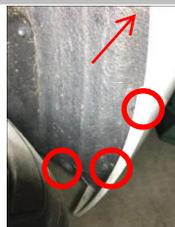
2.2、拆下后包围左右两侧各4颗螺丝（有颗在箭头上），左右方法一致
