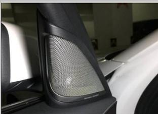
1.4、拆下原车三角板，原车有喇叭需先把拆下，复原装在我司三角板上
